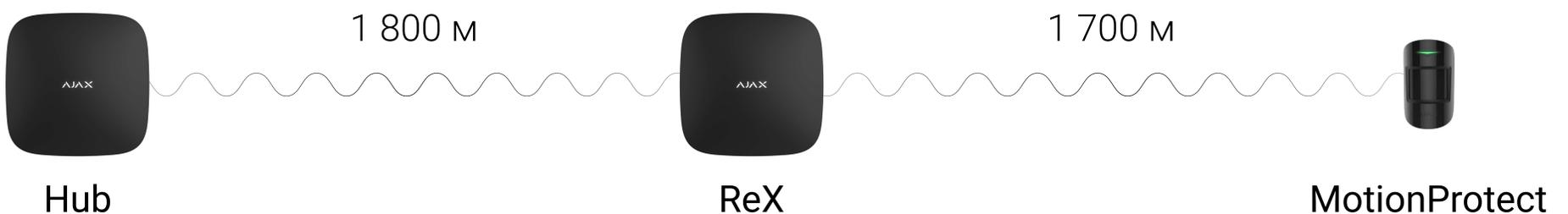
Предельная дальность радиосвязи с подключенными устройствами — 1700 метров при отсутствии преград. К системе безопасности Ajax можно подключить до 5 ретрансляторов, что позволяет использовать ее для защиты масштабных объектов. Независимо от количества подключенных к ретранслятору устройств, тревоги доставляются за 0,3 секунды.
