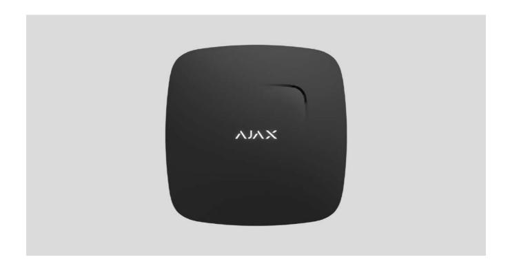
**FireProtect Plus** — беспроводной пожарный датчик для помещений, оснащенный зуммером. Работает до 4 лет от батарей. Определяет наличие дыма и резкий рост температуры. FireProtect Plus дополнительно реагирует на опасный уровень СО. Датчик может работать автономно от хаба.
